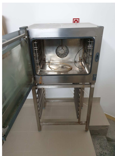
i. Piec konwekcyjno-parowy Unox XC30 model XUC 304 moc 5.3 kW 5-io półkowy Padova Włochy
