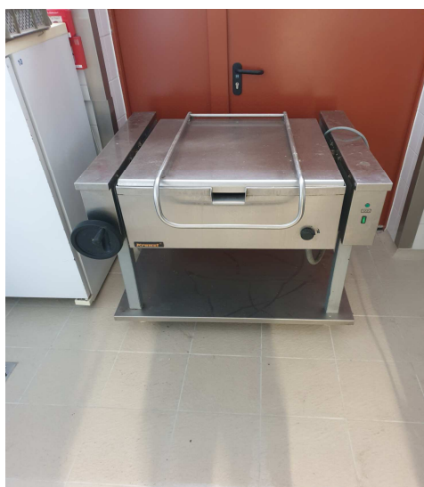
h. Bema podgrzewacz wolnostojący elektryczny wodny W8-3 3xGN1/1 moc 3,6kW Gastromasz Bydgoszcz
