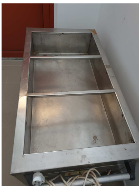
h. Bema podgrzewacz wolnostojący elektryczny wodny W8-3 3xGN1/1 moc 3,6kW Gastromasz Bydgoszcz
